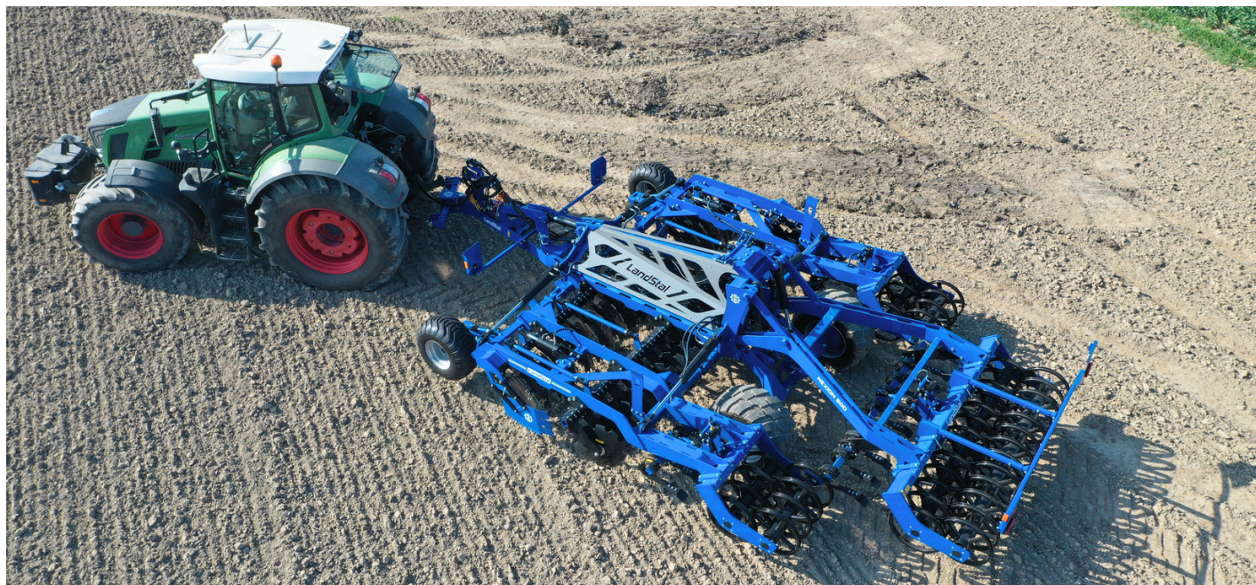
Голямата маса на машината позволява стабилна и значително по-бърза работа (до 20 км/ч); теглото на транспортната количка по време на работа добавя натиск върху машината и предотвратява нейното "подскачан"
