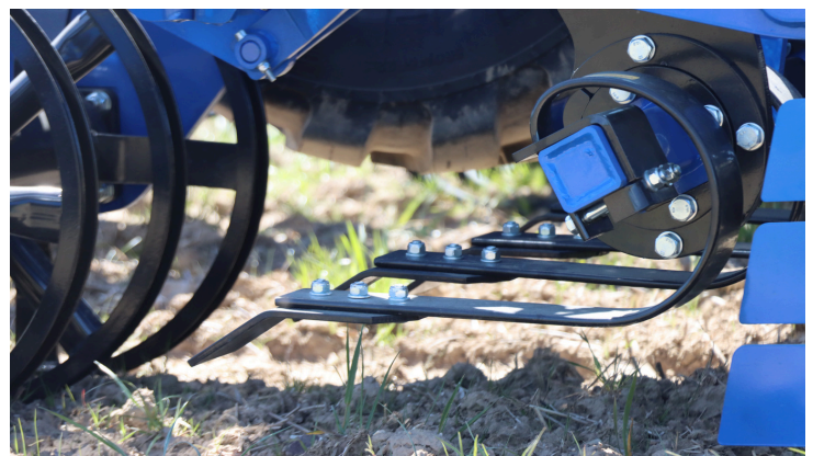
Crushboard - delante del rodillo (ajuste hidráulico)
