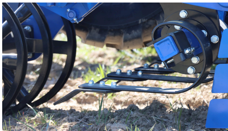
Crushboard - davanti al rullo (regolazione idraulica)
