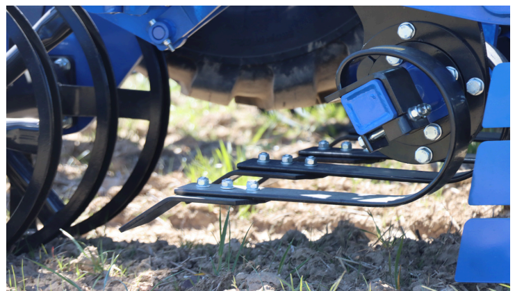
Crushboard - în fața tăvălugului (reglaj hidraulic)
