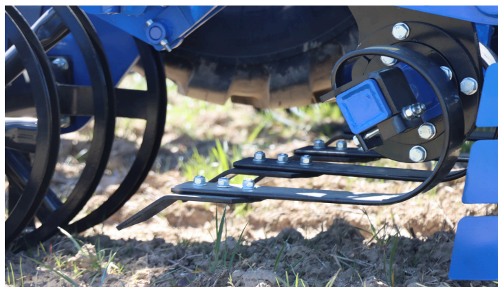
Włóka CRUSHBAR – przed wałem (hydrauliczna regulacja)
