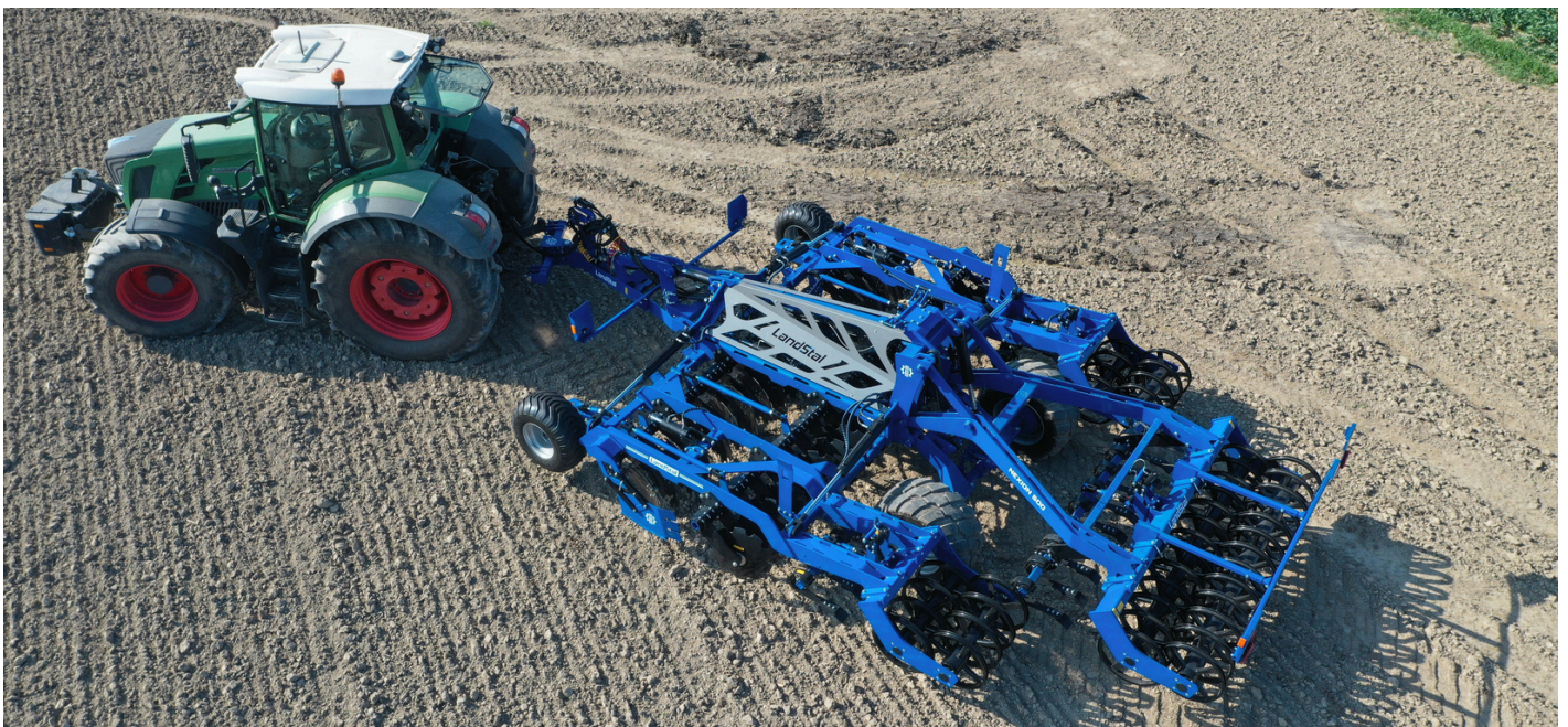
Duża masa maszyny pozwala na stabilną i znacznie szybszą pracę (nawet do 20 km/h), ciężar wózka transportowego w trakcie pracy dociąża maszynę i zapobiega "podskakiwaniu" maszyny.
