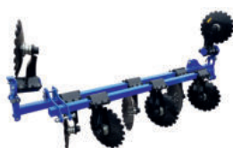
Rangée de disques sécurité caoutchouc de Ø 460 mm - OPTION
