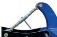
Règlage par 3 points de la profondeur de travail - STANDARD
