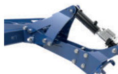
Réglage hydraulique de la profondeur de travail - OPTION
