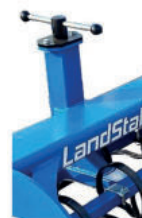
Réglage par broche de la profondeur de travail - STANDARD
