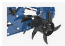
Papildomi hidraulinio būdu sulankstomi šoniniai volai - PAPILDOMAI
