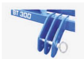
Megerősített kat. 2 és 3 függesztés - ALAPFELSZERELTSÉG
