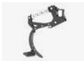
Двойно-пружинна защита до 600кг. съпротивление - опция
