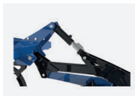
Hydrauliczna regulacja głębokości pracy - STANDARD
