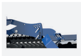
Płynna regulacja głębokości pracy - STANDARD
