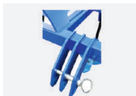
Wzmocniony zaczep 2 i 3 kategorii - STANDARD
