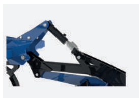
Hydrauliczna regulacja głębokości pracy - STANDARD
